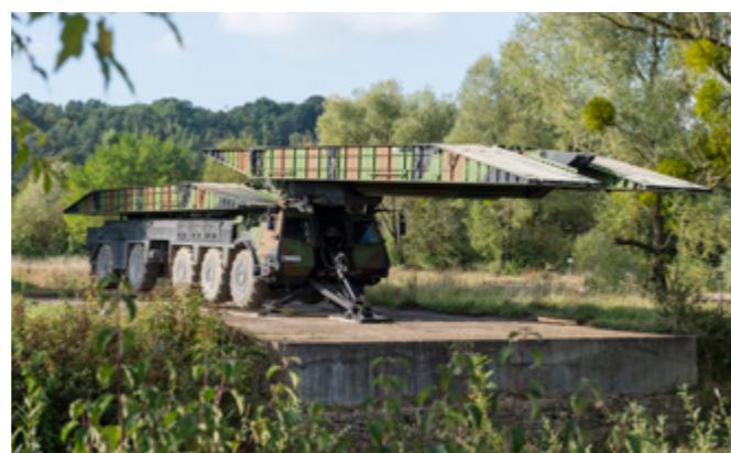
▲ Construction rapide Pont court 14 m en 8 min / Pont long 26 m en 10 min
