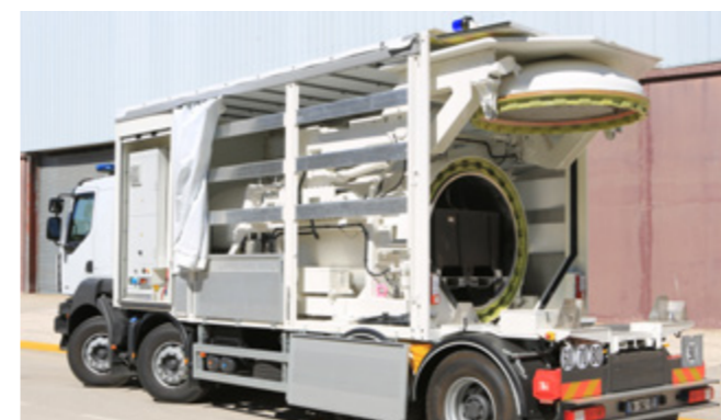
▲ 13kilos Eq. TNT : résistance de la cuve
