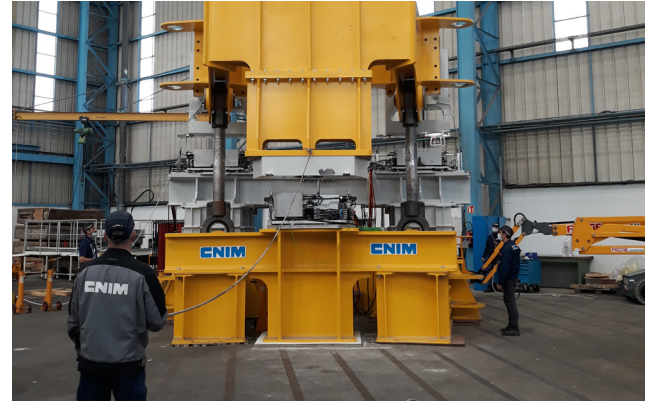
Tester un outillage de montage de composants pour le réacteur de fusion ITER.
