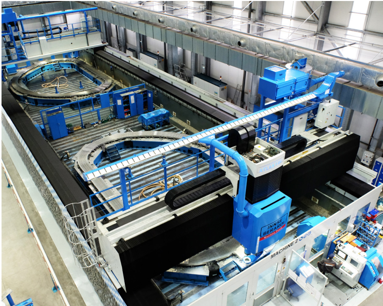
Fraiseuse double portique (X 30000, Y 9000, Z 1250 mm, charge max. : 5 tonnes / m 2 ).
