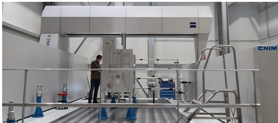
Contrôler au 10 ème de millimètre près avec la machine ZEISS MMZ-G. ( X 4000 Y 8000 Z 2000 mm).
