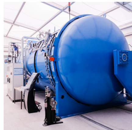
Four autoclave pour les pièces en composite.
