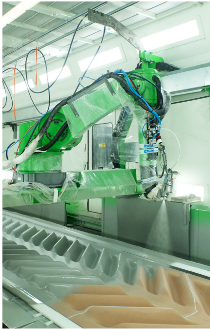
Pulvérisation robotisée de polyuréthane.
